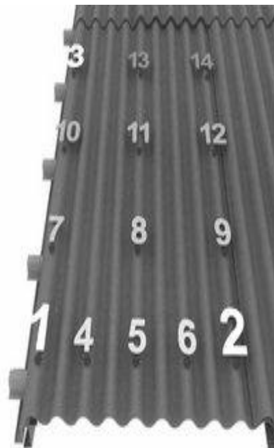
Principskiss av fixeringsordningen. Skissen visar 14 fixeringspunkter vilket är onödigt mycket.
